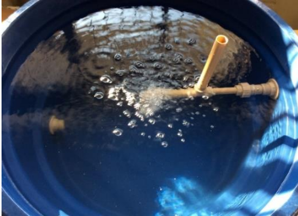
Fig. 12. Aerador em operação.
