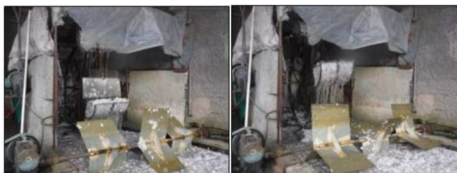
Fig. 12. Máquina onde é realizada a secagem do plástico comum
