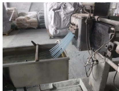
Fig. 15. Plástico após ser derretido é posto com formato de macarrão
