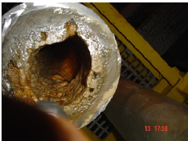
Figura 6 - Duto com incrustação de BaSO<sub>4</sub>
